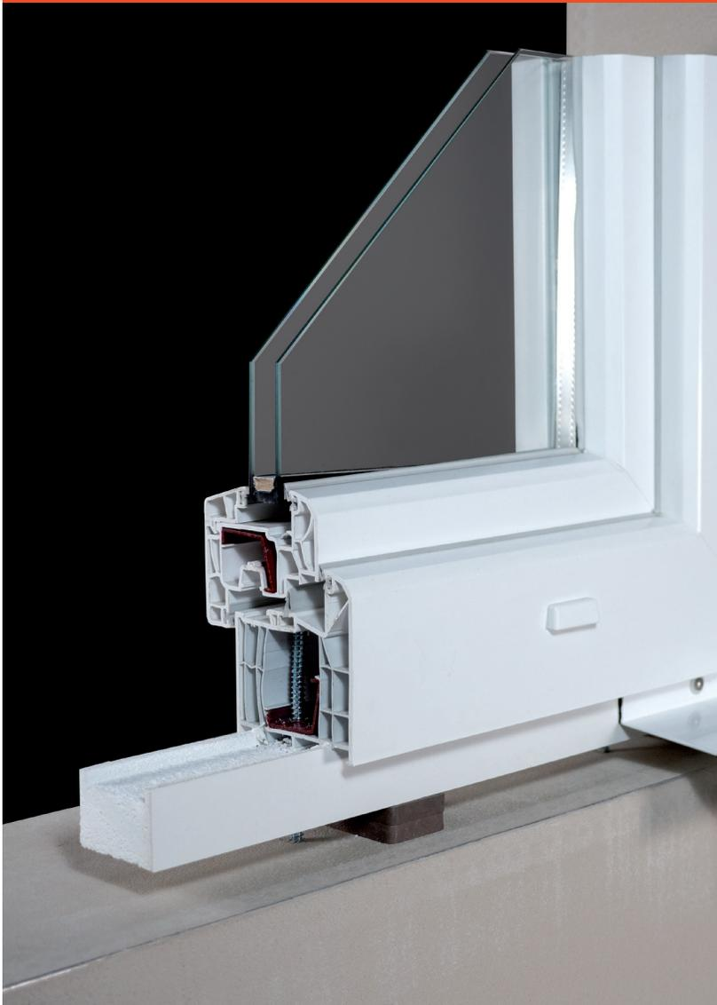
Der CF-Fensterbankanschluss ersetzt herkömmliche PVC-Fensterbankanschlussprofile. Mit dem optimalen Lambdawert von COMPACFOAM gehören Tauwasser und Schimmelbildung im Bereich des FBA der Vergangenheit an. Durch die hohe Festigkeit von CF-FBA ist auch die Befestigung der Fensterbank mit speziellen Fensterbank-schrauben ohne Probleme möglich. In Verbindung mit der PVC Oberfläche kann die Fensterbank auch mit handelsüblichen Fensterbankschrauben befestigt werden.
